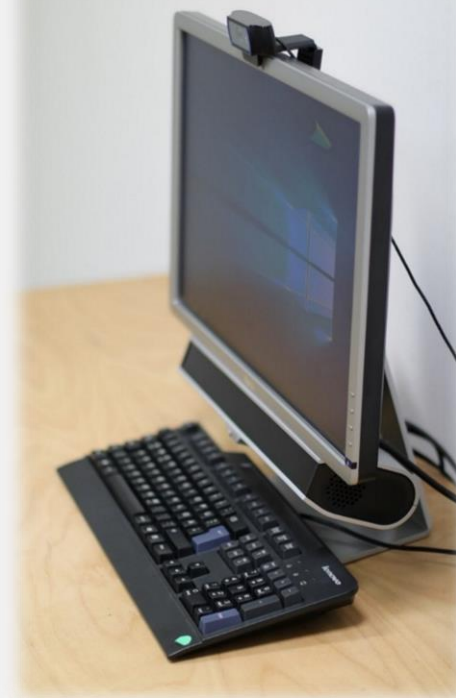
Uređaj za praćenje pokreta oka koji se koristi za analizu web-stranica ili drugih stimulacija na ekranu računala.
